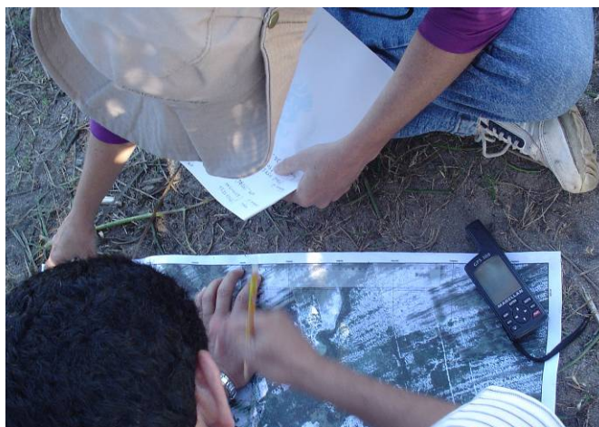
Foto 1 – Exemplo do uso do GPS para os procedimentos de georeferenciamento dos pontos de campo.
